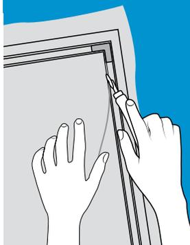
Auxiliar en el reemplazo de mosquiteros de aluminio ó fibra de vidrio, que emplean marcos hechos a base de perfiles con canal para empaque plástico (spline).
