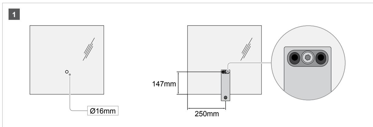
Instalación de vidrio sin barreno CC-791
