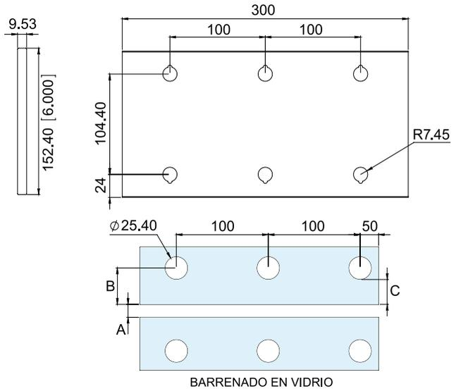
Para determinar la posición de los barrenos en el vidrio:
