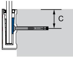
Hormigón comprimido: C = 60mm
