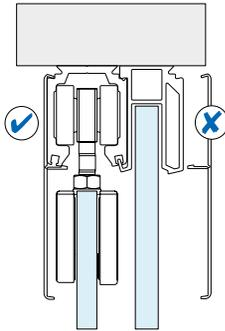
\*El perfil tapa lateral solamente se instala con el riel 2200300 / 500NA y utilizando la carretilla 1200000CA
