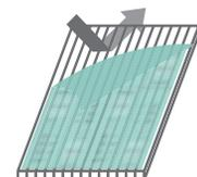
**8** Una lámina puede ser curvada perfectamente en frío con dirección longitudinal. Los radios de curvatura varían entre 750 y 1500mm según el espesor de la plancha. No se deben instalar los alveolos en forma perpendicular a la pendiente, la estructura alveolar no está diseñada para trabajar en sentido inverso.
