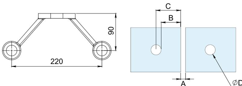
Para determinar la posición de los barrenos en el vidrio:
