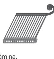
**6** Protege los bordes inicial y final de la plancha con perfiles de policarbonato tipo "U".
