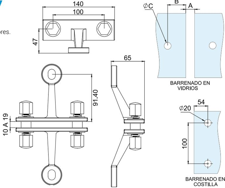
Para determinar la posición de los barrenos en el vidrio:
