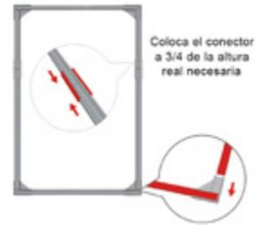
**3** Ensamble las tiras de PVC con los soportes esquineros. Podrás ajustar el largo necesario de tu marco con los conectores (Coloca el conector a 3/4 de la altura real necesaria).
