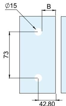
Para determinar la posición de los barrenos en el vidrio:
