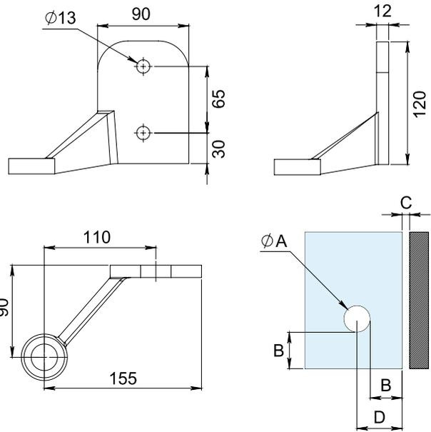
Para determinar la posición del barreno en el vidrio:
