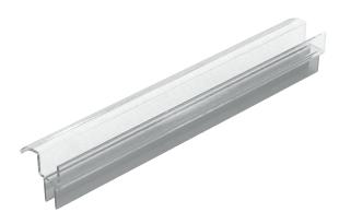
Perfil de policarbonato Xochimilco tipo sellapolvo con doble aleta central flexible, y aleta rígida de desagüe. Para cristal de 9mm de espesor y con 2.50m de largo.
