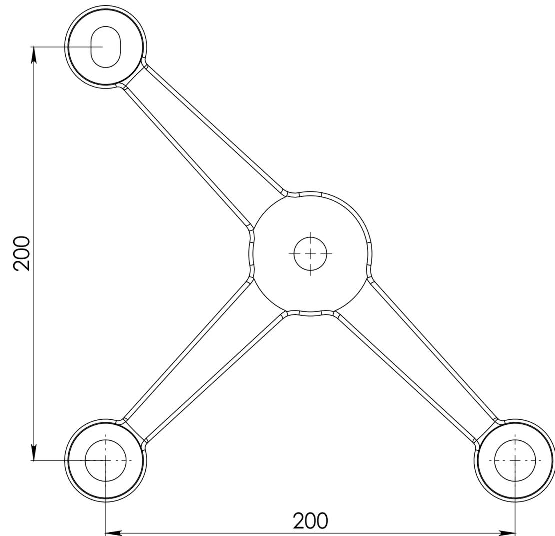
**PARA DETERMINAR LA POSICIÓN DEL BARRENO EN EL VIDRIO**
