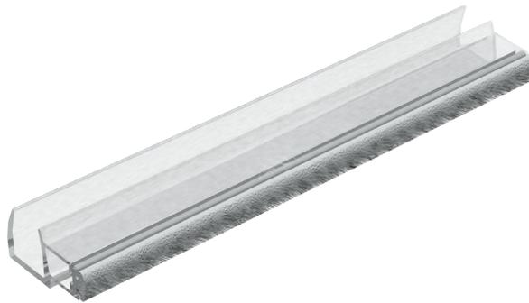
Perfil de policarbonato tipo "F" con portafelpa para puerta corrediza. Cuenta con 2.50m de largo y es para cristal de 9mm de espesor.
