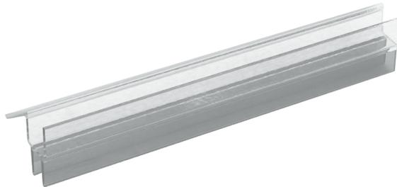
Perfil de policarbonato tipo sellapolvo, con doble aleta central flexible y aleta rígida de desagüe, para vidrio de 6mm de espesor. \*Largo de 2.50m.
