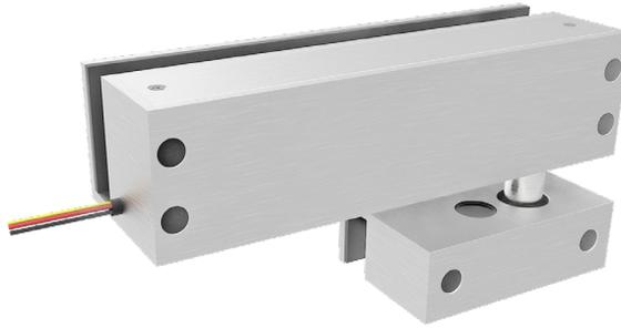
Solenoide Acambaro para puertas de cristal templado. Compatible con interfonos y sistemas de control de acceso. Consumo mínimo de energía, con operación a 12 V DC. Cierre automático al alinearse la grapa con el solenoide. Cuenta con un mecanismo interno para mayor seguridad. \*Incluye cuerpo principal y contra. \*\*Este producto funciona con el transformador 123401200 (De venta por separado).
