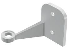
Araña Querétaro izquierda de 1 pata, con base conector a muro. \*Compatible con rótulas 1203. \*\*No incluye tornillería. Fijar a muro con tornillo de 1/2" cabeza hexagonal grado 2 SAE ó A307 ASTM.
