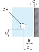
Para determinar la posición del barreno en el vidrio:
