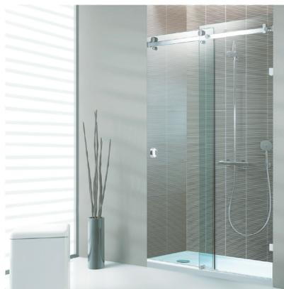
Cancel de baño para vidrio templado de 8 a 10mm de espesor, con un vidrio fijo y una puerta corrediza. Componentes fabricados en acero inoxidable. Recomendado para una medida máxima de 1.80m, sus carretillas soportan un peso de 65kg por par.
