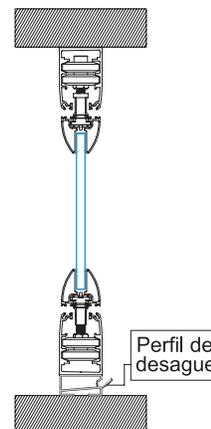
INSTALACIÓN CON PERFIL DE DESAGÜE
