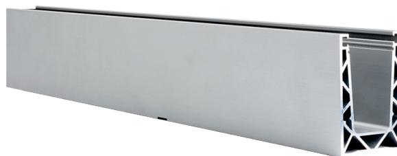
Riel de barandal SV-1501 con 5m de largo, para instalación de paneles de cristal. Se caracteriza por su diseño estético, funcional y esbelto donde la fijación va oculta en la parte interior. Al ser un perfil simétrico se puede instalar en ambos lados sin diferencia alguna, lo cual facilita su instalación (Modelo SV-1501 Glassfit 10-12mm).
