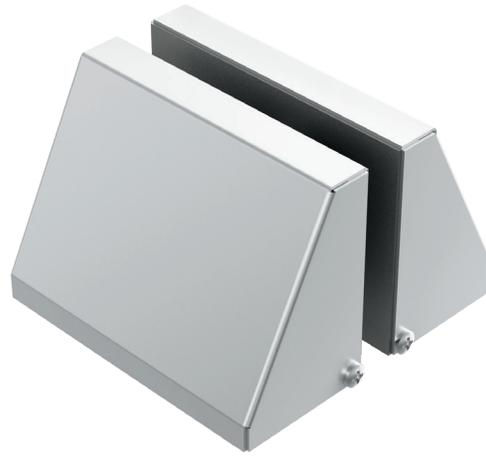
Conector Peña de Bernal para instalación de cristales fijos, instalar un conector máximo cada 1.50m de separación. Diseñado para interiores, no soporta cargas de viento. Fabricado para vidrios no mayores a 1.20m de alto. \*Instalar a piso, muro ó techo con tornillo hexagonal 5/16" y taquete expansivo.
