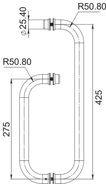
Jaladera Pátzcuaro tubular de 1" de diámetro con sistema de ensamble por medio de tornillo y cono integrado. Combinación de jaladera larga y jaladera corta. Medida de línea parte corta 30cm largo total con 27.5cm de centro a centro y parte larga 45cm largo total con 42.5cm de centro a centro.
